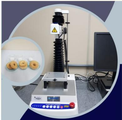
*O transporte pneumático reduz a granulometria dos cristais de açúcar. A redução do tamanho dos grânulos de açúcar promove aumento na dureza de biscoitos tipo rosca sabor leite.*
